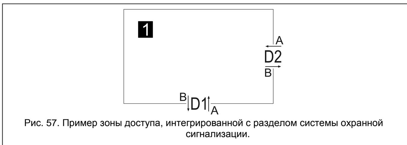
Рис. 57. Пример зоны доступа, интегрированной с разделом системы охранной сигнализации.
